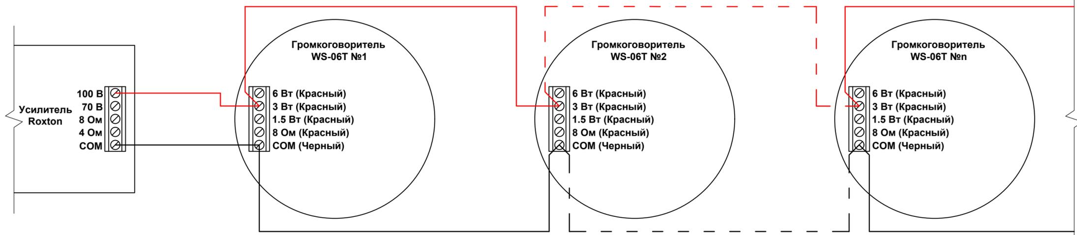
**3. Схема подключения настенных громкоговорителей WS-06T к 100 В выходу усилителя на мощность 1.5 Вт**
