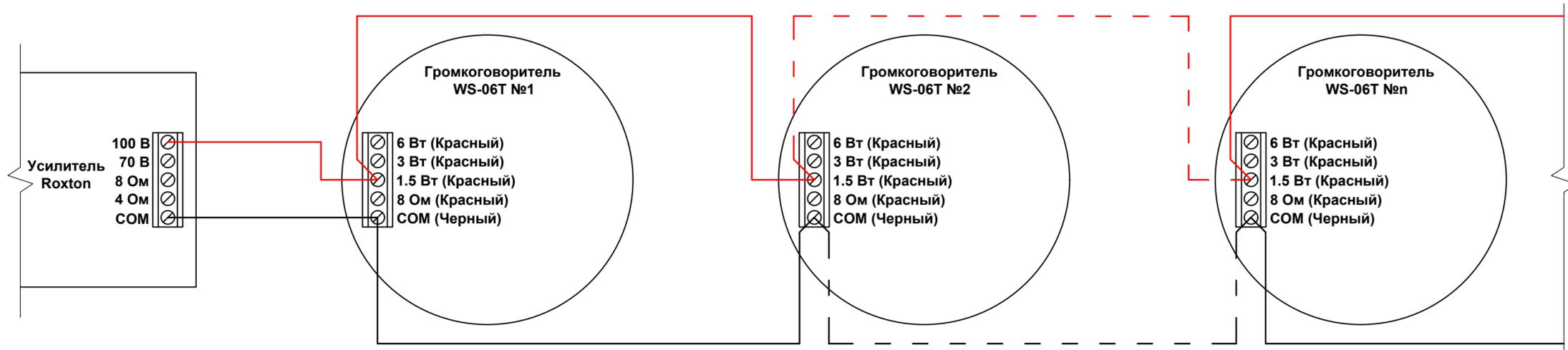
**4. Схема подключения настенных громкоговорителей WS-06T к 100 В выходу усилителя на мощность 6, 3 и 1.5 Вт (смешанное подключение)**
