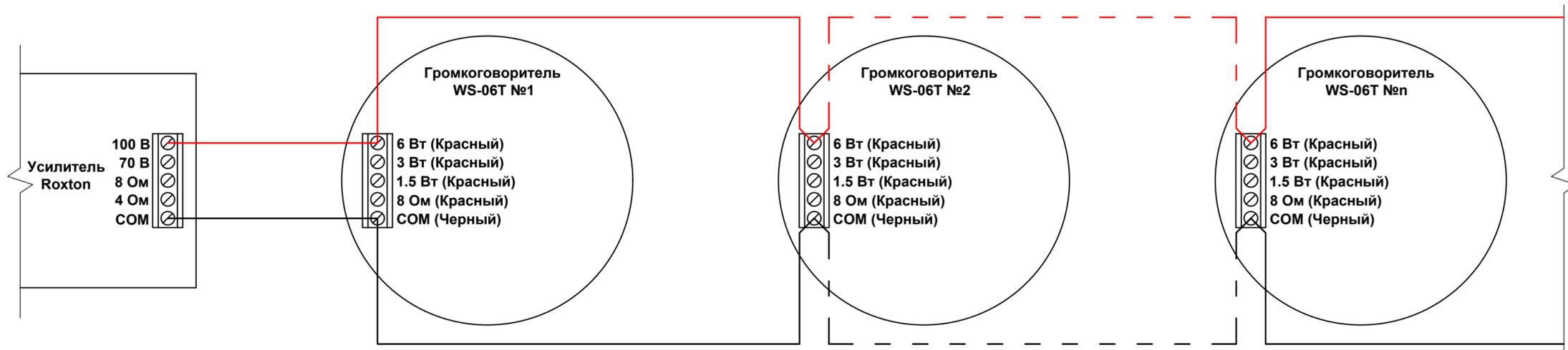
**2. Схема подключения настенных громкоговорителей WS-06T к 100 В выходу усилителя на мощность 3 Вт**
